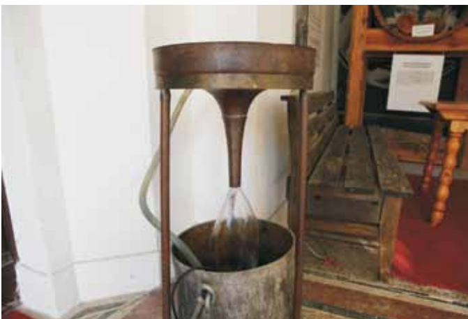
Versuchseinrichtung zur Wasserverwirbelung
